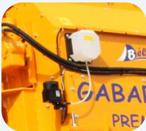
Graissage automatique des chaînes de convoyeur
